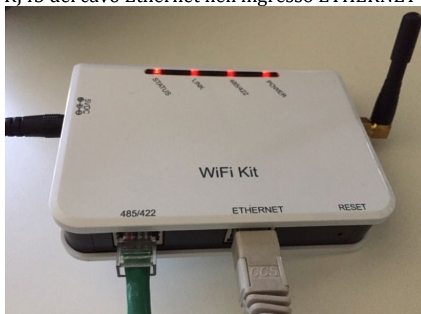
Figura 89 – Cavo Ethernet collegato al datalogger
