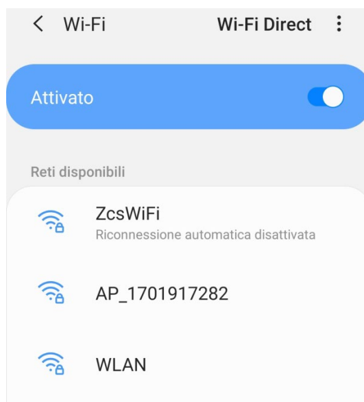
Figura 45 - Disattivazione della riconnessione automatica a una rete
