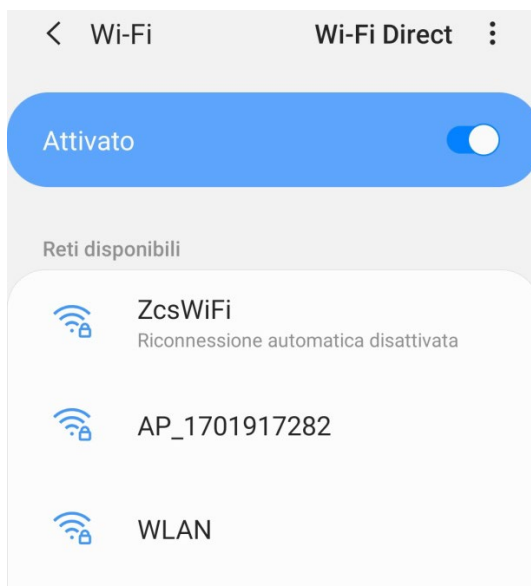
Figura 91 - Disattivazione della riconnessione automatica a una rete
